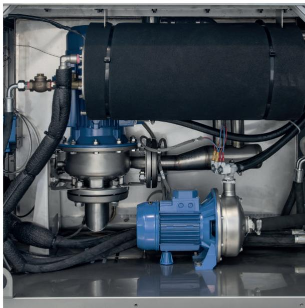
Per garantire la massimizzazione della qualità del ciclo, il modello LCF 1500 3P è dotato di due pompe in fibra da 2,6 kW che lavorano a piena potenza. I modelli 4k, adatti ai lavori più gravosi, montano due pompe in acciaio inox da 4kW, le più potenti della loro categoria.
